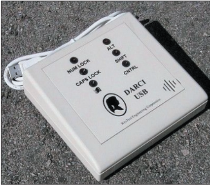
Figura 4: Darci usb, dispositivo de acceso al ordenador mediante morse. Morse.
