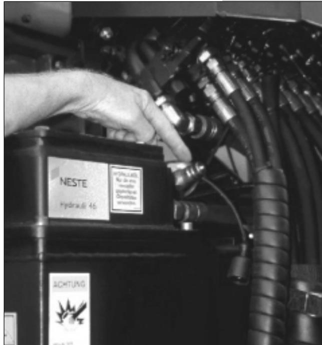
Abb.1: Schnellkupplung zum leckfreien Austausch von Hydraulikflüssigkeit
