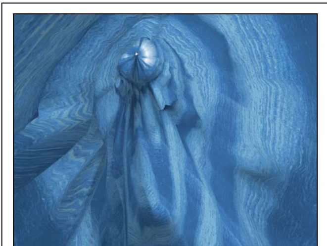
3D Innenansicht in einen Hintersolungsbereich vom Kavernenboden aus (mit CavWalk erzeugt)
