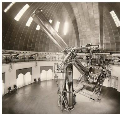
Der Potsdamer Große Refraktor ist ein Doppelfernrohr mit 80 bzw. 50 cm Linsendurchmesser. Er wird zur Zeit restauriert.
