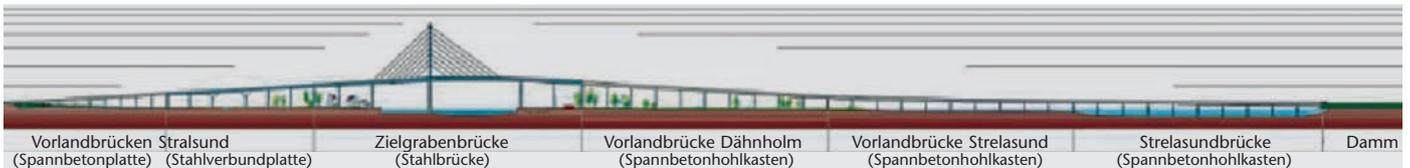
Abb. 9: Brückenabschnitte und Brückenarten
