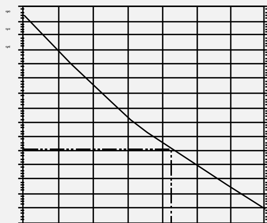
Fig. 2. Permeabilidad al vapor de agua del aire a 23 °C.
