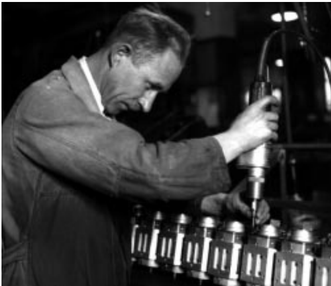
Bosch mit Bosch gefertigt: Magnetzündler-Montage mithilfe von Bosch-Schraubern, 1937
