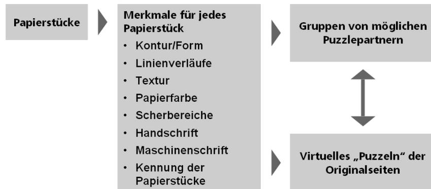
*Bild 5:* Bestandteile des Prozesses der virtuellen Rekonstruktion
