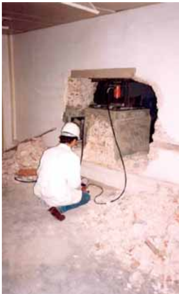
Fig. 6 – Ensaio de corte destrutivo.
