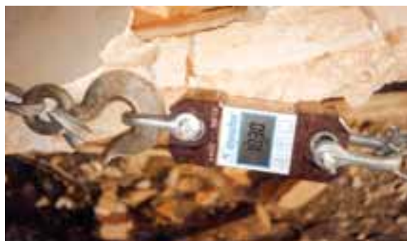
Fig. 7 – Ensaio destrutivo de arrancamento, realizados in situ . (a) Sistema de carga; (b) Célula de carga.
