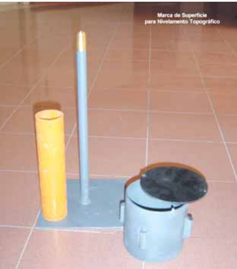
Fig. 4 – Esquema de instalação das marcas de superfície.
