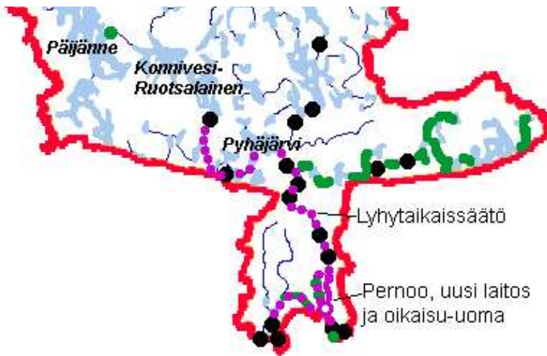
Kuva 17. Kymijoen alaosan tulvasuojelu- ja voimatalousratkaisu, mikä mahdollistaisi myös lyhytaikaisen säädön.
