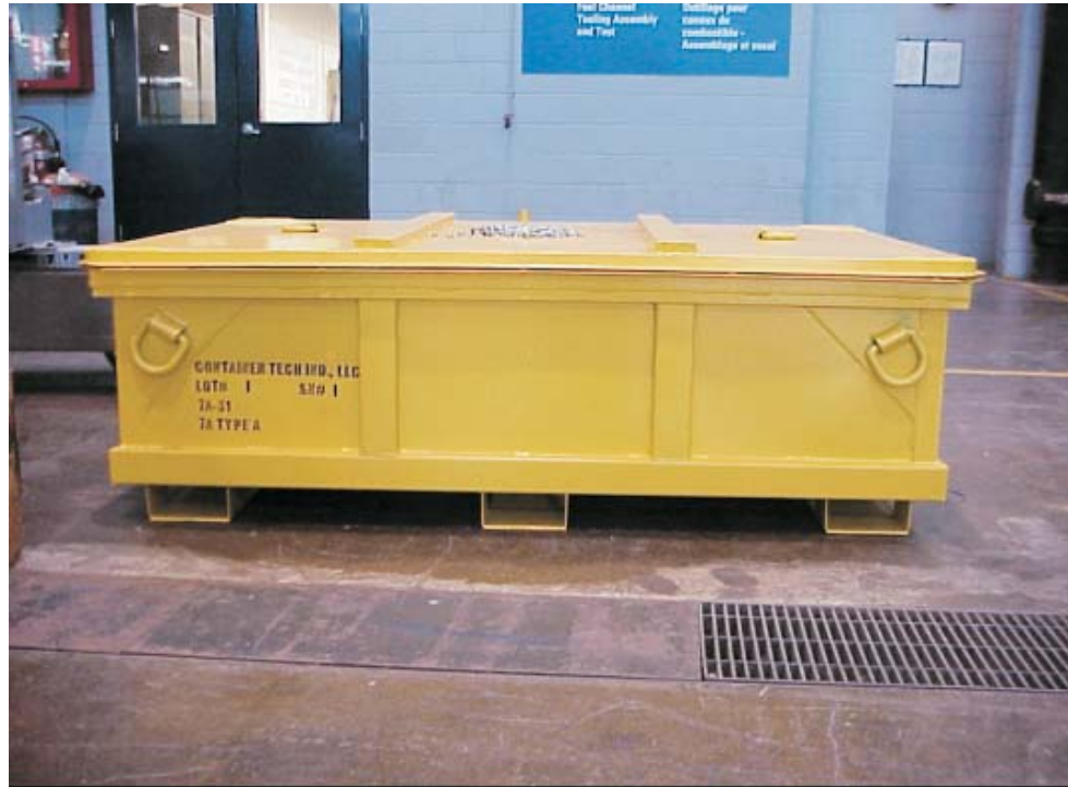
Figure 3-23 : Boîte métallique pour le transfert et le stockage des déchets non compactables de faible et de moyenne activité résultant du retubage
