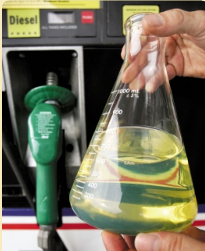
Una mezcla más saludable. Una muestra de combustible B20 que contiene un 20% de biodiesel y 80% de diesel estándar. El biodiesel fabricado de aceite vegetal químicamente alterado se quema de manera más limpia que el combustible diesel tradicional.
