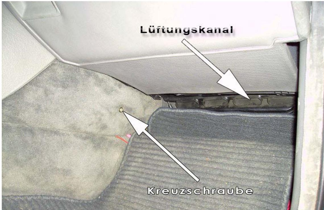
dann das Handschuhfach zu machen auf den Rücken in den Fußraum legen mit dem Kopf unters Handschuhfach, das Handschuhfach öffnen (wird sehr eng da unten) die Arme verdrehen usw. den grünen Stecker vom Heizschwert abziehen, die zwei Kreuzschrauben öffnen (auf dem Bild rechts zu sehen) und das Schwert rausziehen
