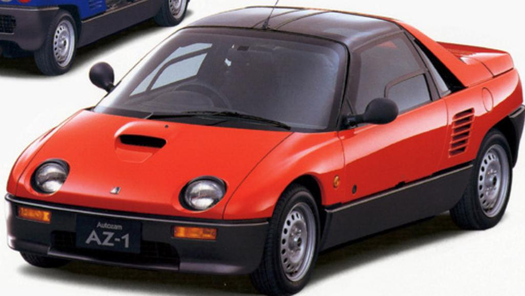
89年東京モーターショーに初出品された、アウターパネルの張替えを可能とするコンセプトカーから発展した軽自動車のミッドシップスーパースポーツ。このモデルのシリーズ生産化については疑問視する声も多かったが、軽自動車の規格改定を経て、さらに2年後の'92年10月に遂に正式デビューを果たした。アビアランス上の最大の特徴は、なんといってもガルウィングドアであろう。同じ東京モーターショーには、他にグループC2カー風のモデルなども出品されたが、結局生産化されたのはこのミニスーパーカー風のボディのみであった。ミッドシップに横置き搭載され後輪を駆動するエンジンは、スズキから供給されるアルト・ワークスと共用のもの。直列3気筒DOHC12バルブ+ターボで660ccから64PSを発揮した。あまりにも強い個性と、ややトリッキーで乗り手を選ぶ操縦性が災いしてか、極めて短命に終わってしまった。ところが、現在では中古車市場で新車当時並みの高価格で取引される一方、多くがイギリスなど海外に流出し、彼地で貴重品扱いされるという珍現象も起きている。
