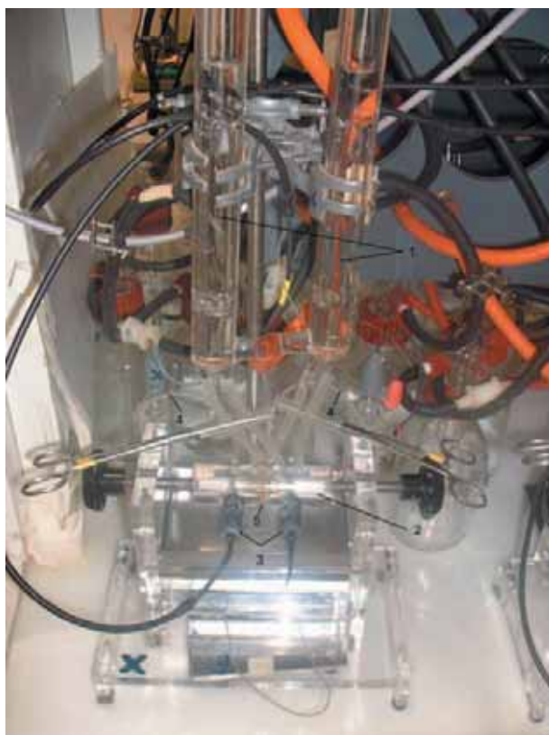
Abb. 5: Gesamter Aufbau der Ussing-Kammer-Messapparatur 1 = Gaslift und Pufferreservoir, 2 = Ussing-Kammer, 3 und 4 = Messelektroden, 5 = Lage des Schleimhautpräparates
