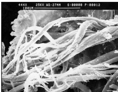
Fig. 9: Cristalli di carbonato di calcio tra le fibre di collagene: la natura chimica dei cristalli è stata identificata focalizzando l'immagine ottenuta al microscopio elettronico a scansione e rivelando la presenza del calcio tramite il sistema di microanalisi che utilizza la tecnica EDS (Energy Dispersion System), tramite la quale si analizzano le radiazioni X emesse tipiche degli elementi eccitati dal fascio di elettroni primario
