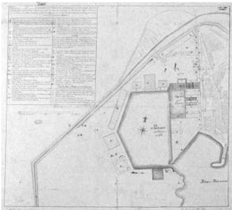
“Explicacion del plan proyectado del puerto de Cartaxena y su arsenal, que comprende los edificios necesarios para los armamentos y desarmos de navios y sus carenas, como tambien todos los demas precisos en un Departamento.” Ciprián Autrán, 1747. AGS, M.P. y D. IV-73
