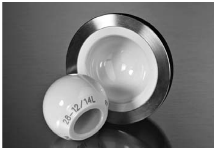
Europäisches Museum für Technische Keramik „Hochspannung, Hochöfen und Hightech – Keramik auf höchstem Niveau“: Keramischer Kugelkopf und Pfanne für künstliches Hüftgelenk, CeramTec, Lauf.
