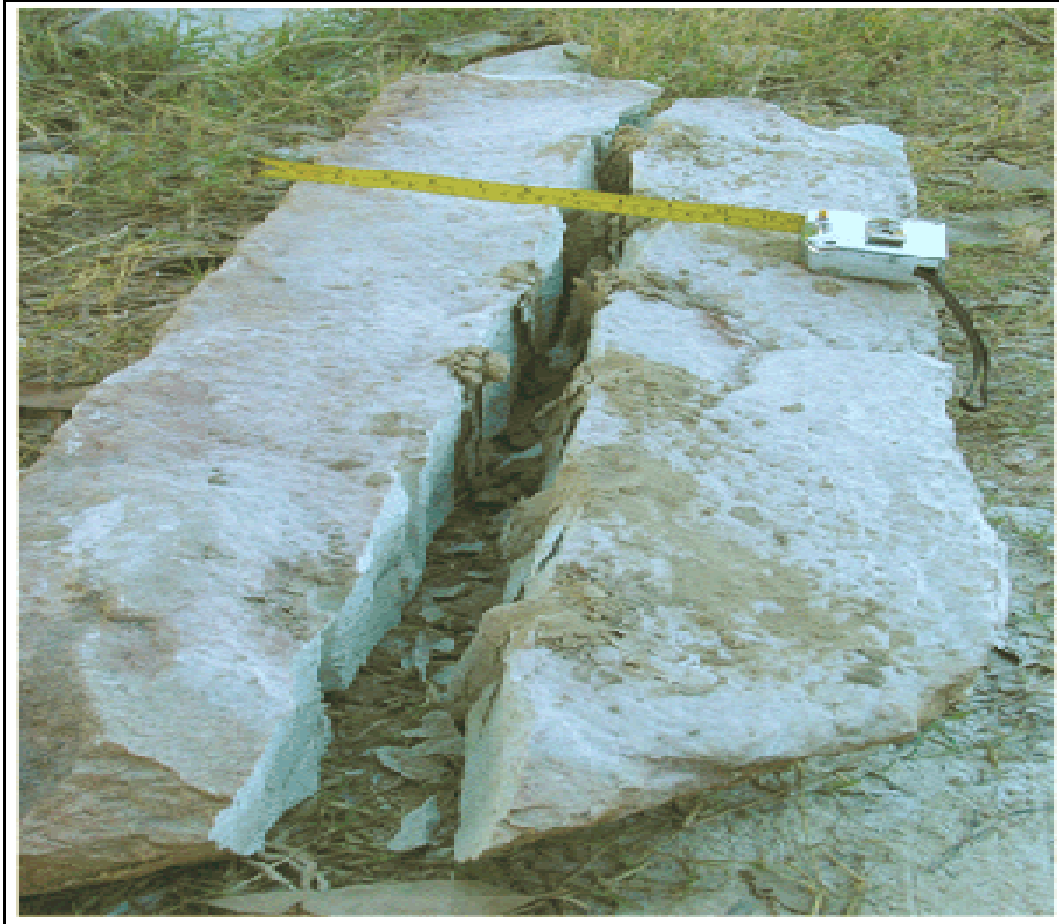
Foto 23 - Vista do bloco de quartzito após a evolução do plano de fratura: 20 h oras.
