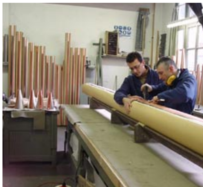
Costruzione di una canna del Principale 16' del Grand'Organo
