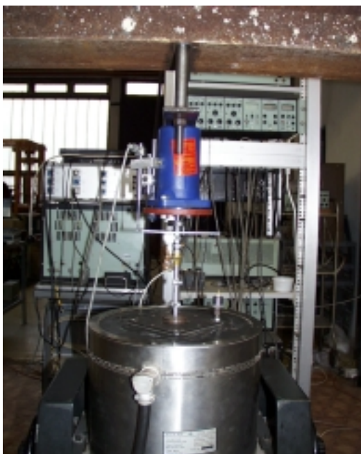
3.5. ábra Biztonsági szelep rezgetővizsgálata
