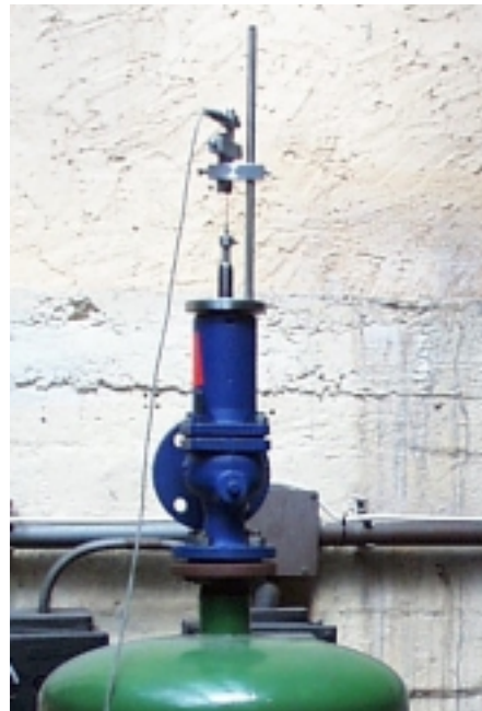
II.3. ábra A mérőtartályra szerelt, felműszerezett biztonsági szelep
