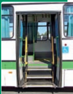
4-5. Ikarus C56.32-es a középső ajtónál beépített rokkantlifttel
