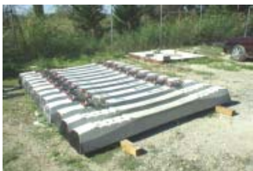
図8. ジオポリマーコンクリートによる枕木の試作品
