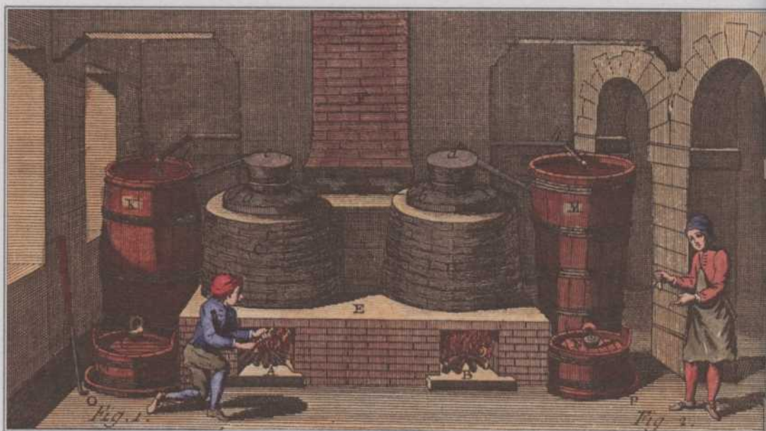
LA DESTILACIÓN DEL AGUARDIENTE, grabado publicado en el volumen de artesanías del siglo XVIII. La ilustración muestra el interior de una destilería, con un horno de ladrillo alimentado con leña por uno de los obreros, y sobre el que descansan las calderas. El otro obrero se encarga de probar el licor que sale del serpentín. El grabado va precedido de una noticia explicativa: «Destilador de aguardiente». ♦
