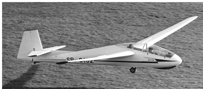
Szkolna wersja SZD-9 bis-1E Bocian – E; widoczne trapezowe usterzenie
