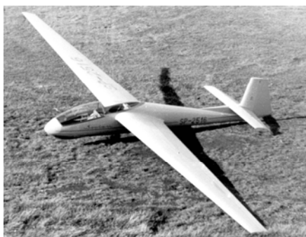
Bocian – E; widoczne proste końcówki skrzydeł
