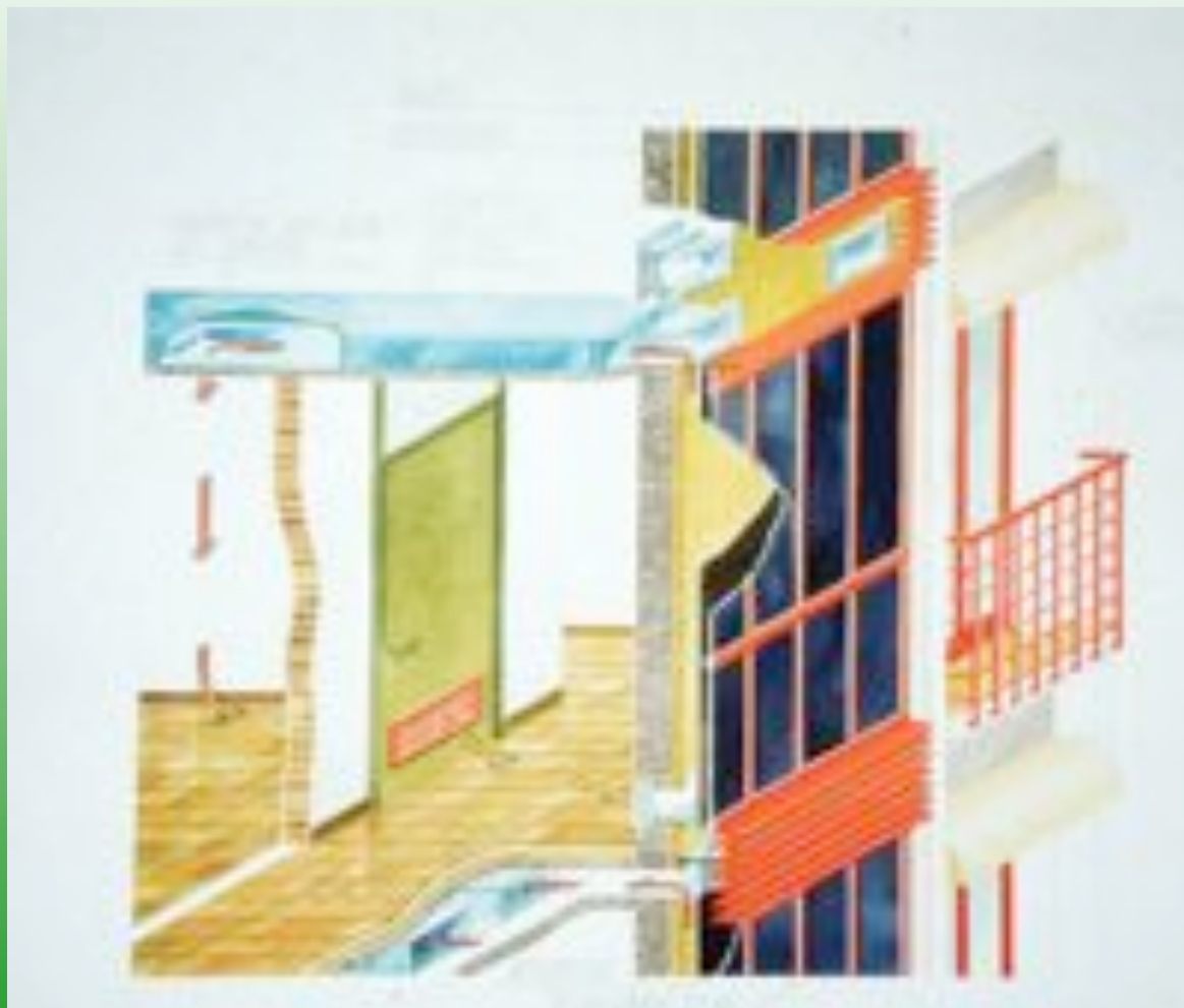
Schema assometrico del funzionamento in assetto inverno giorno
