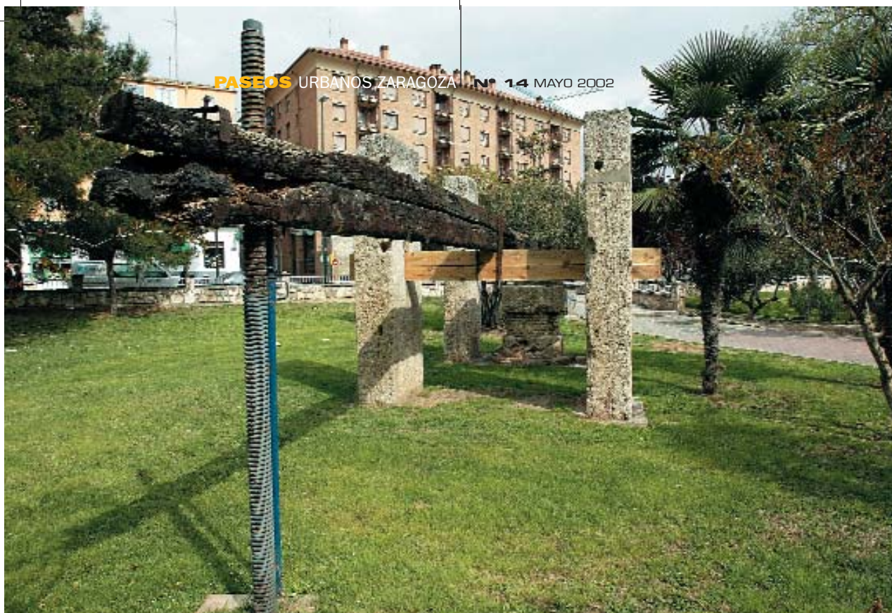
Memoria de la prensa de viga y libra que exprimía la oliva en la almazara de Juan Martín de Goicoechea.
