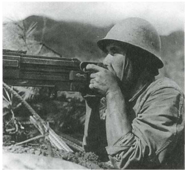
*Китай. Пулеметчик одет в летний мундир образца 1930 года со знаками различия, переставленными на воротник. Он ведет огонь из станкового 6,5-мм пулемета Тип 3. Этот пулемет, принятый на вооружение в 1914 г., был разработан на базе французского «Гочкиса». (Библиотека Роберта Ханта)*
