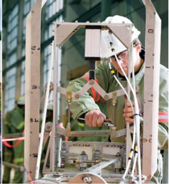
À la centrale de la Rivière-des-Prairies, un ingénieur ajuste l'un des composants du robot multifonctionnel submersible utilisé pour diagnostiquer l'état des pièces encastrées.
