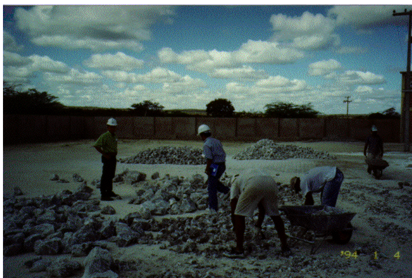
Figura 3 – Pátio de catação manual da gipsita em uma das empresas produtoras de gipsita no pólo gessoiro de Pernambuco.
