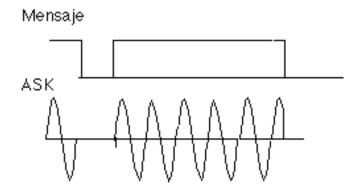
ASK puede ser definido como un sistema banda base con una señal para el "1" igual a  $s_1(t)$  y una señal para el cero igual a  $s_0(t) = 0$ .
