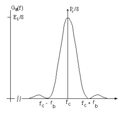
Se observa que el ancho de banda práctico es 2f<sub>b</sub> el cual es el doble del requerido en transmisión banda base. Otro parámetro que será muy útil sobre todo en modulación multinivel es la constelación que a continuación definiremos:
