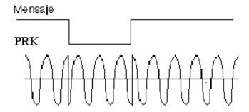
La densidad espectral de potencia DEP de la señal PRK viene dada por:
