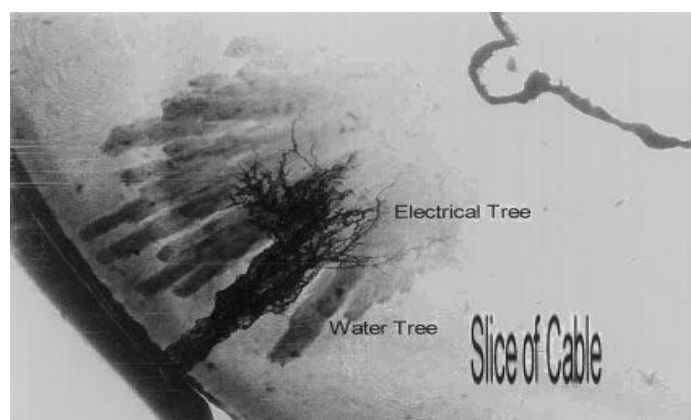
Fig 1. Formación de arborescencia acuosa a arborescencia eléctrica
