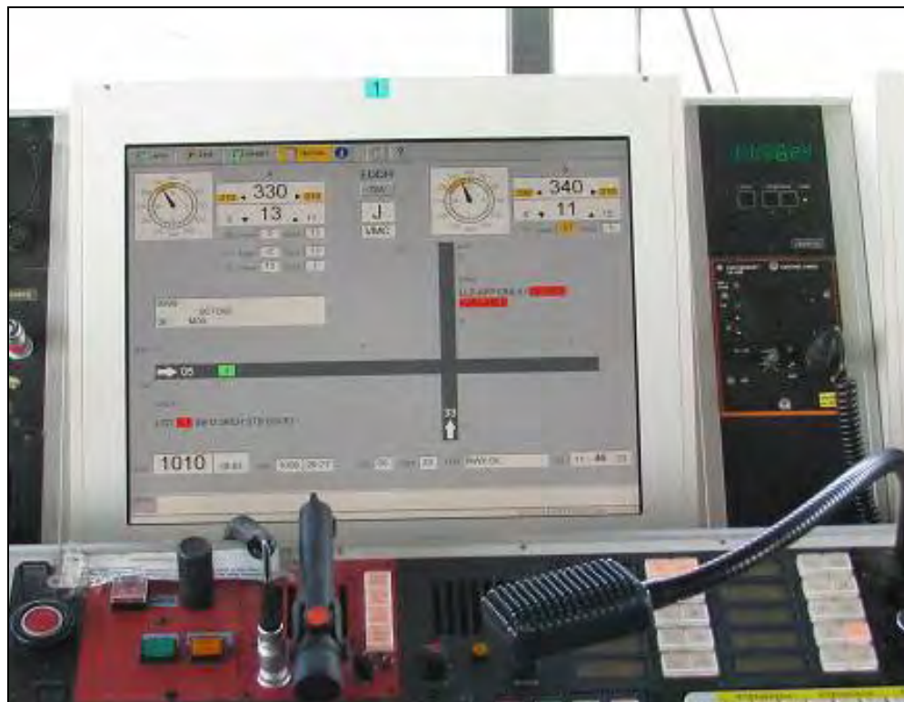
Abbildung 5: Anzeige der Windwerte im Tower
