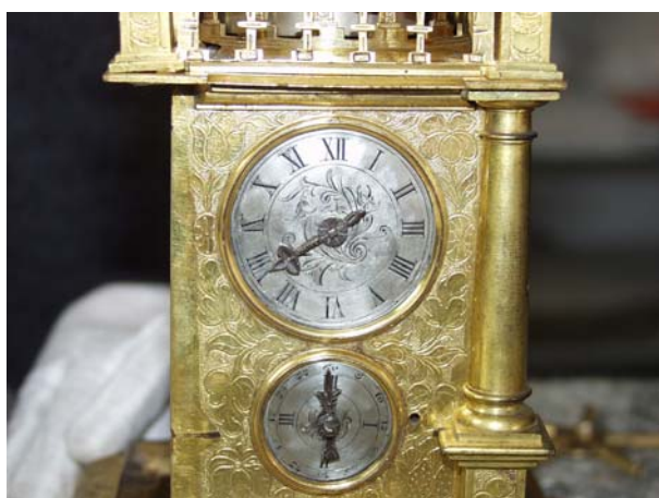
Abb. 46: Zeiger aufstecken, Schlagwerk mit Zeitanzeige synchronisieren, Vorsteckstifte einsetzen
