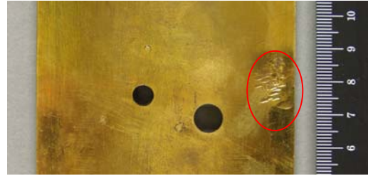
Abb. 15 a: Ausbeulung von hinten (Kreis) mit Hammerspuren
