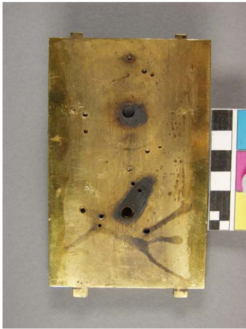
Abb. 14: Schauseite von hinten – Blindlöcher und Rinnsuren
