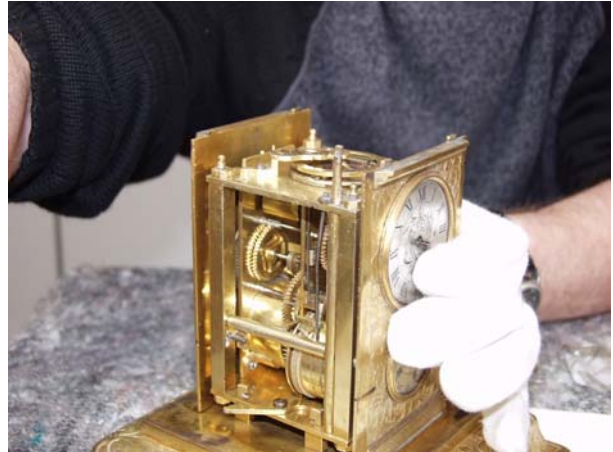
Abb. 39: Vorderes und hinteres Blech aufsetzen
