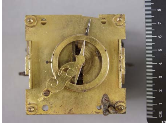
Abb. 3: Aufsicht Werk mit Spiralfeder
