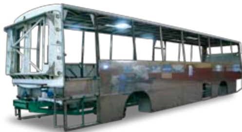
Habillage de la caisse en panneaux inox pour la pérennité.
