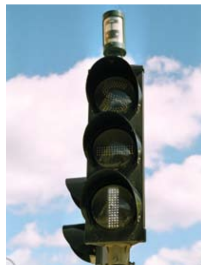
Indikeringslampor som lyser när bussen har detekterats (Göteborg respektive Stockholm)
