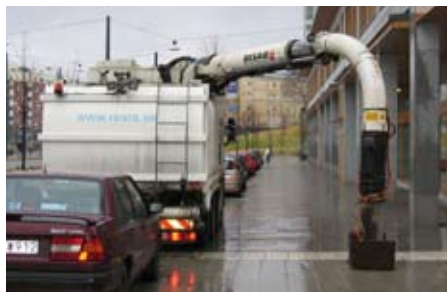
Sopbil med vakuumsug vid en av dockningspunkterna för det mobila sopsugsystemet.
