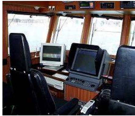
Interiör från styrhytten med radar och elektroniskt sjökort
