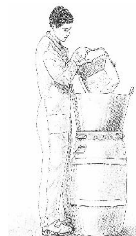
Tamisage et stockage de la chaux éteinte
