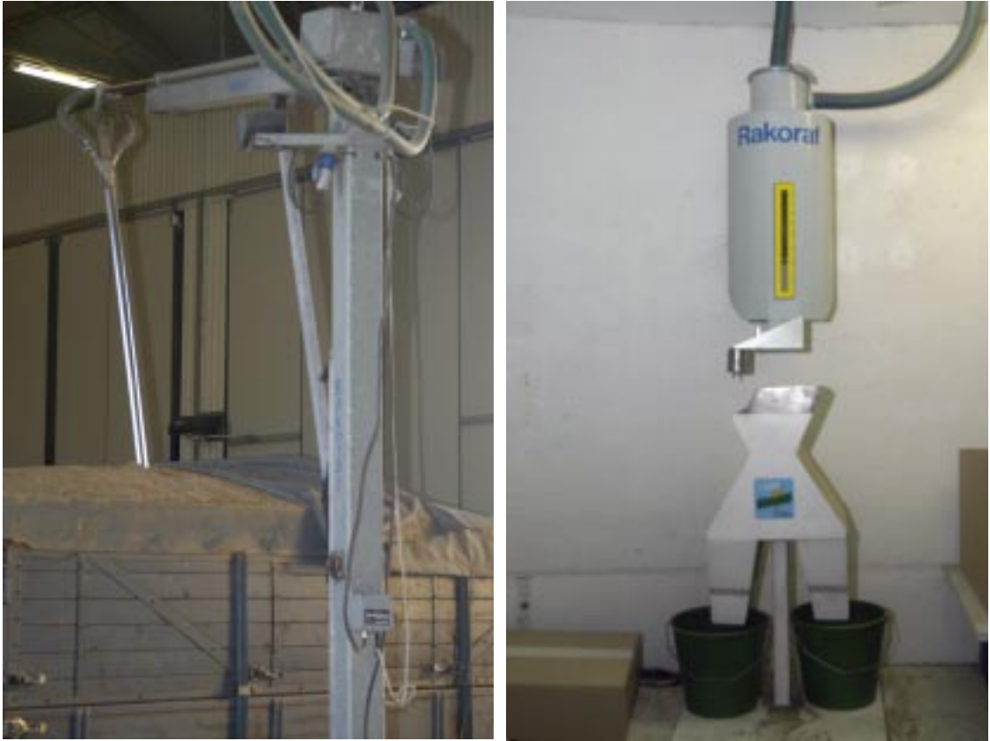
Prover tas ur leveransen (vänster bild). Via ett rör delas provet i två burkar (höger bild). Ett prov skickas till AnalyCen i Kristianstad för kontroll av exempelvis vattenhalt, volymvikt och proteininnehåll. Man tar också falltal, ett mått på bakhingsdugligheten, för att avgöra om leveransen passar bäst till mjöl eller foder. Provnnummer två behåller Lantmännen i Brålanda som referensprov vid avräkningen till lantbrukaren. Foto: OE, RMVG.
