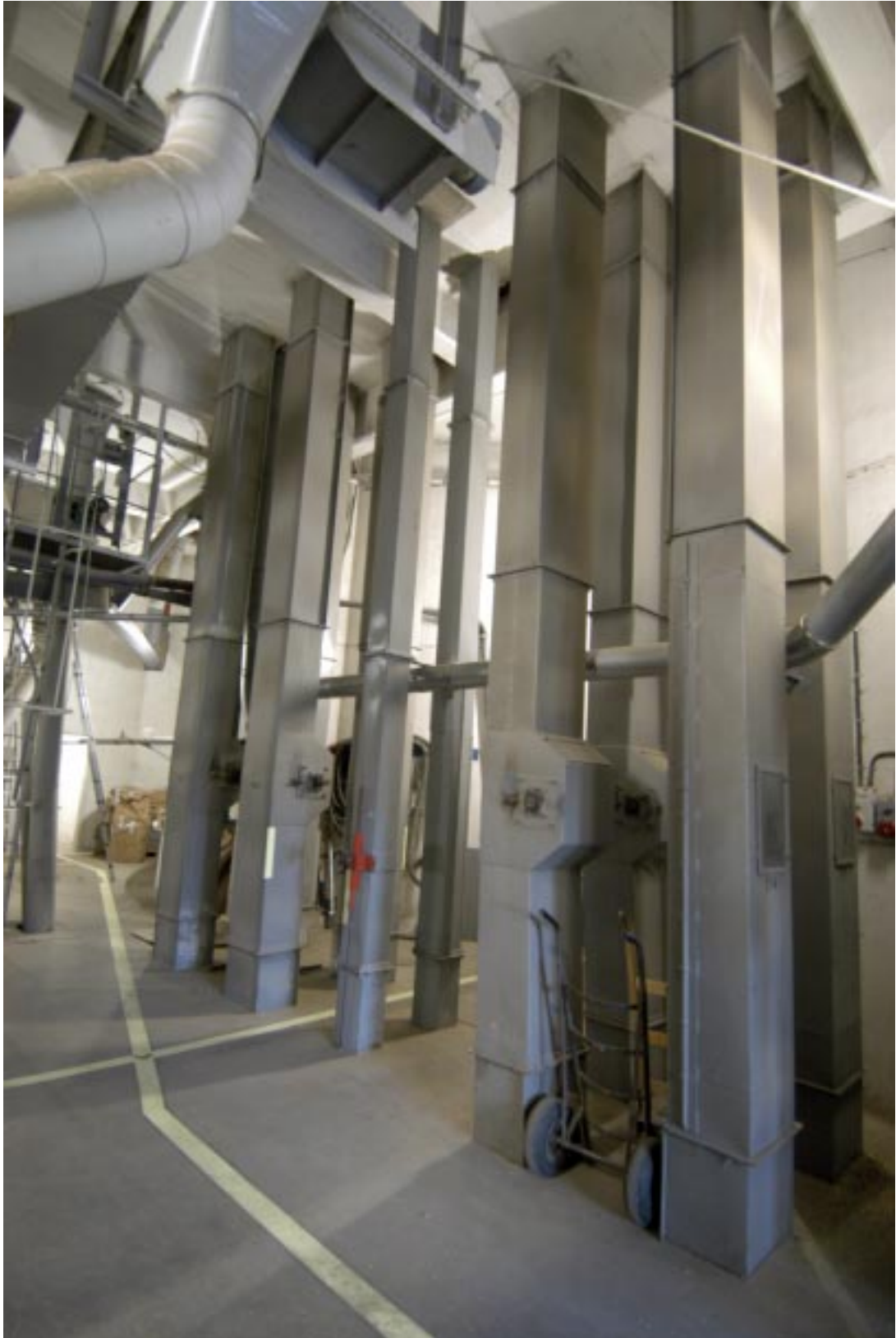
Via skopelevatorer lyfts spannmålen upp genom maskintornets våningsplan. Foto: OE, RMVG.
