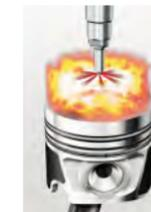
**Die Voreinspritzung** führt zu einer „weichen“ Verbrennung und damit zu einer ausgezeichneten Verbrennungsakustik und einem angenehmen Motorlauf.
