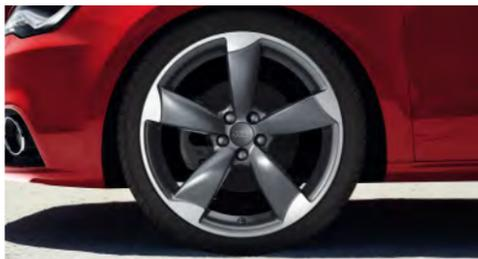
■ **Aluminium-Gussräder Audi exclusive im 5-Arm-Rotor-Design in Titanoptik, glanzgedreht**, Größe 7,5 J x 18 mit Reifen 225/35 R 18. Ein Angebot der quattro GmbH
