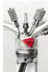
**Die Motorsteuerung** berechnet die Einspritzmenge und den Zündzeitpunkt nach der Leistungsanforderung des Fahrers. Im Normalbetrieb liegt der Einspritzdruck zwischen 30 und 120 bar.
