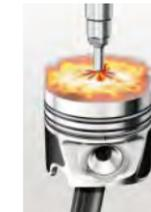
**Die Piezo-Injektoren** öffnen und schließen sich innerhalb von Bruchteilen von Millisekunden und spritzen mehrmals mit bis zu 1.600 bar in den Brennraum ein. Bei einem Einspritzvorgang werden teilweise winzigste Mengen von weniger als einem Tausendstel Gramm eingespritzt.
