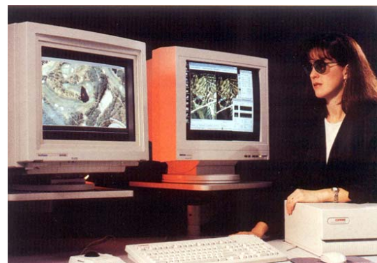
Figura 3. Sistemas de visualización con polarización gafas pasivas (LH Systems).
