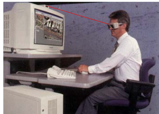
Figura 4. Sistemas de visualización con polarización de gafas activas (ImageStation ZIII, Intergraph)
