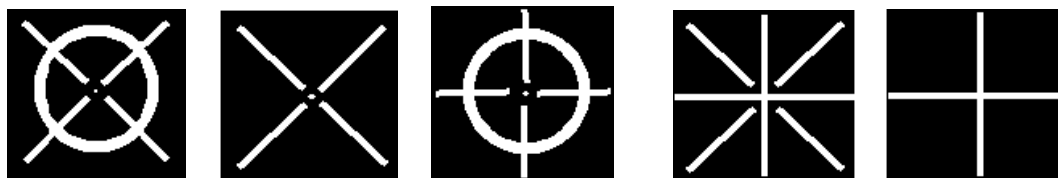
Figura 8. Aspecto de diversas marcas fiduciales según tipos de cámaras.
