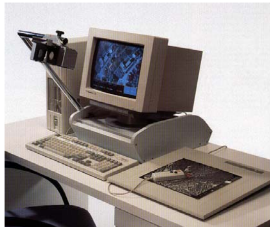
Figura 5. Sistemas de visualización por división en pantalla (DVP de Leica).
