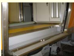
ステップと床面の段差 縮小 (従来比▲45mm)
