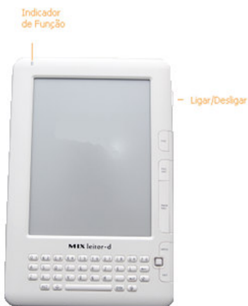
Figura 4: Frente do dispositivo com o Indicador de Função e o botão Ligar/Desligar destacados.
