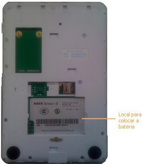
Figura 2: Parte posterior do dispositivo aberto, com indicação de onde colocar a bateria.
