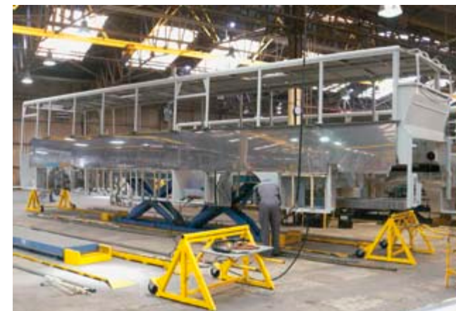
▲ Habillage de la caisse en panneaux inox pour la pérennité.
