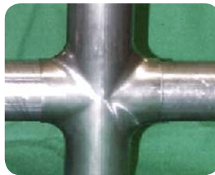
하이드로포밍 (hydroforming) 된 용접튜브, 1.4003.
