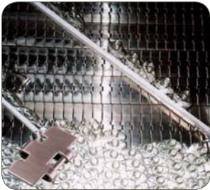
컨베이어벨트 (CONVEYOR BELT)
