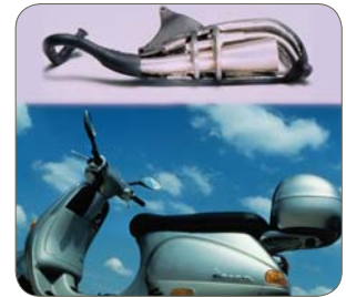
EN 1.4509/441, Centro Inox, 이탈리아 새로 출시된 Vespa ET2 에는 400 계를 사용한 촉매 소음기가 장착되어 있다.
