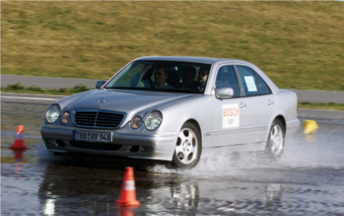
Bild 2: ESP-Erprobung auf nasser Fahrbahn
