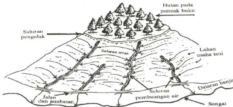
Gambar 15. Letak saluran pengelak, saluran pembuangan air, dan saluran teras pada suatu bukit (Sketsa: F. Agus)
