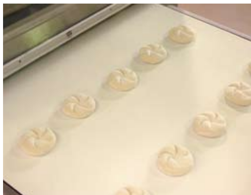
Übergabe der Teiglinge in den Nachgärschrank. Alternativ könnten sie auch als grüne Teiglinge direkt in den Spiralfroster übergeben werden.
