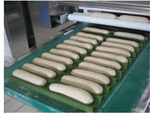
Die Station zum Ablegen der lang gerollten Brote auf Backbleche.
