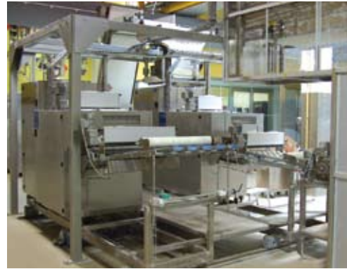
Unterschiedliche Gewichtsbereiche: Eine Besonderheit der Anlage sind die zwei Kopfmaschinen des Typs Industrie Rex, die unter einem Teigtrichter, der fest auf einem Untergestell montiert ist, auf Schienen fahrbar sind.
