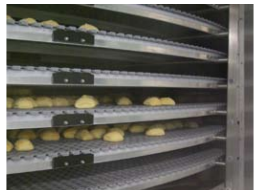
Zum Schluss werden die Backwaren im Schockfroster tiefgefroren und anschließend verpackt.
