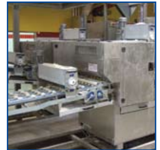
Der Trichter ist auf einem Gestell über dem Teigteiler fest montiert. Je nach Produktgewicht kommt die erste oder zweite Kopfmaschine zum Einsatz.
