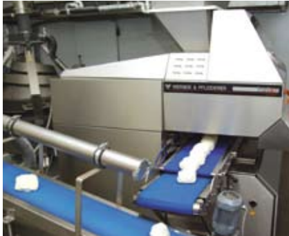
Düsen in dem Rohr über dem Band blasen temperierte Luft über die feuchte Teigoberfläche.
