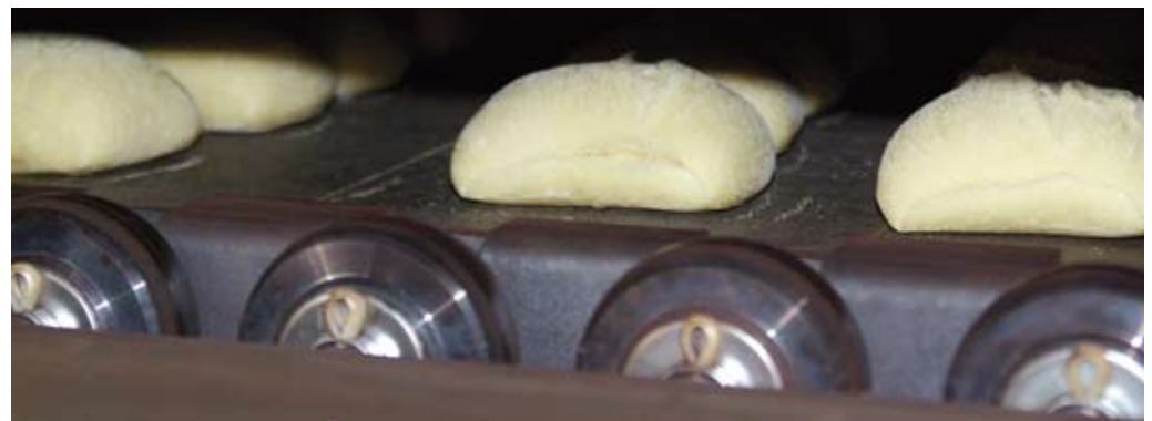
Backwaren auf dem Steinplattenband. Die Wärmezufuhr ist im ersten Moment schnell und direkt, wird aber dann vom Stein gepuffert.
