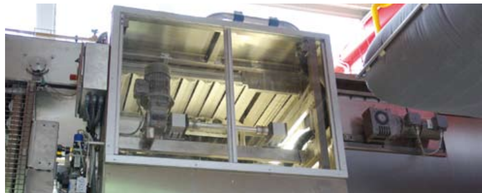
Auf den Kopf gestellt: Bürsten reinigen die Gehänge von unten. Zudem werden sie mit IR-Strahlung desinfiziert.
