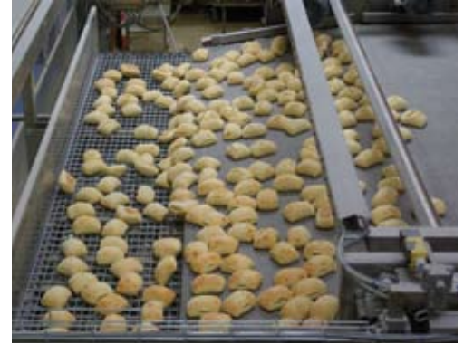
Ausbacken der teilgebackenen Brötchen. Die gesamte Fördertechnik wurde von Kaak installiert.
