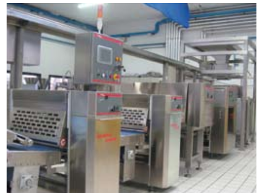
Bei der industriellen Linie wurde sehr viel Wert auf eine schonende Teigverarbeitung gelegt. Der Teig läuft sehr gradlinig und stufenlos durch die Anlage.
