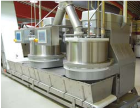
Zwei Diosna-Kneter beschicken die König-Linie. Der Teig gelangt über den Bodenaustrag der Kneter über ein Transportband in den Vorratstrichter über dem Teigteiler.
