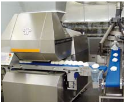
In jeder Linie kommt ein modifizierter Teigteiler V700B von W&P Haton zum Einsatz, ohne Hybridkolben, aber mit einem reduzierten Ölverbrauch.
