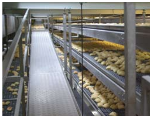
Auf den Transportbändern kühlen die Brötchen langsam auf Raumtemperatur ab.
