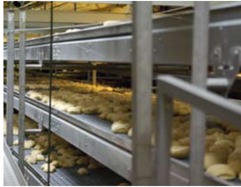
Die teilgebackenen Backwaren zeichnen sich durch eine stabile und gleichmäßige Kruste aus. Die etwas ungleichmäßige Färbung entsteht durch die Enzymatik während der lange Teigruhe.
