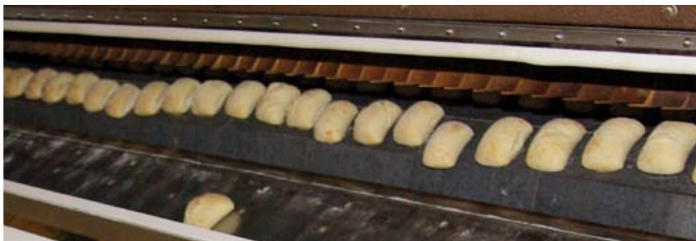
Auf diesem Bild sieht man deutlich den größeren Durchmesser des Steinplattenbandes beim Umlenken. Die Backwaren rutschen vom Band auf den Entlader.
