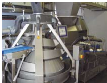
Der Kegelrundwirker ist mit Gebläsedüsen bestückt. Die temperierte Luft bläst die Feuchtigkeit von der Teigoberfläche und verhindert so ein Anhaften des Teigs am Wirkkegel, der wie die restlichen Komponenten der Linie ebenfalls konsequent ohne Trennmittel arbeitet.
