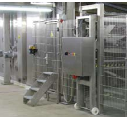
Die Herde im Automatic Hanseat bei Lantmännen sind in Vor- und Ausbackzone unterteilt.
