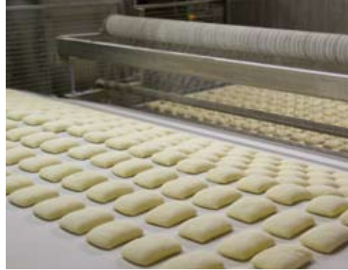
Ein hängendes Netzband gewährleistet durch einen sanften Druck von oben, dass die Teiglinge akkurat auf das aufsteigende Förderband übergeben werden.
