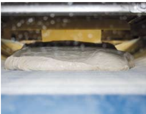
Sehr weiche Teige portioniert WP mittels Relaxer. Mit Hilfe von seitlichen Förderbändern wird der Teig schonend und ohne Anwendung von Druck in großen Blöcken auf das Transportband gelegt.
