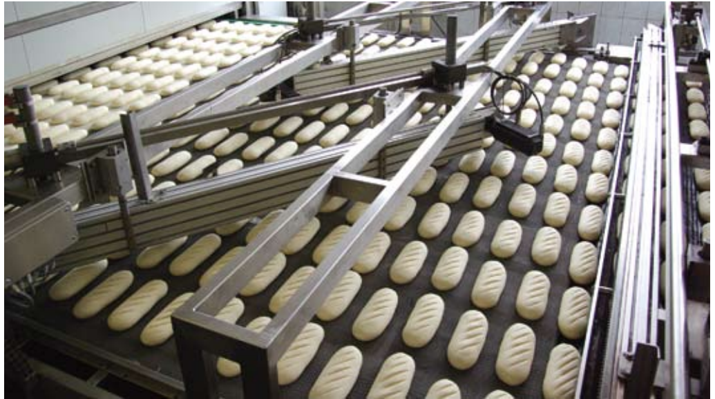
Zwei mal zwei, an je einer Kette gezogene Messer, laufen über dem vier Meter breiten Transportband und versehen jedes Baton mit exakt fünf Schnitten. Diese Anordnung der Messer war notwendig, um die Bandlänge möglichst kurz zu halten.
