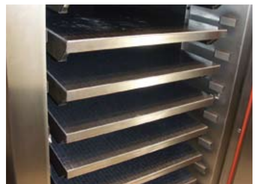
Ein Wagenofen mit Steinplatten auf den Radiatoren, auf denen direkt gebacken werden kann.
