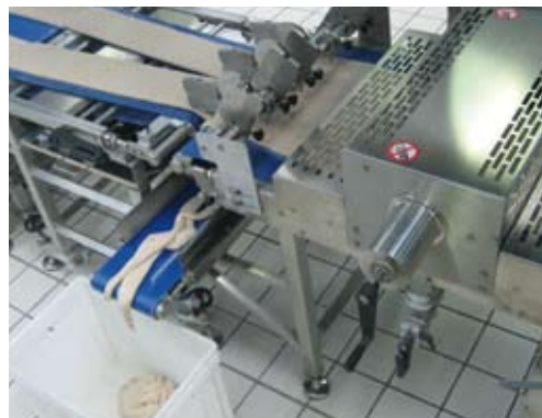
Bei der industriellen Linie wurde sehr viel Wert auf eine schonende Teigverarbeitung gelegt. Der Teig läuft sehr gradlinig und stufenlos durch die Anlage.
