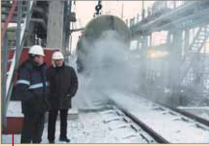
На эстакаде слива нефти из цистерн. Подогрев паром.
